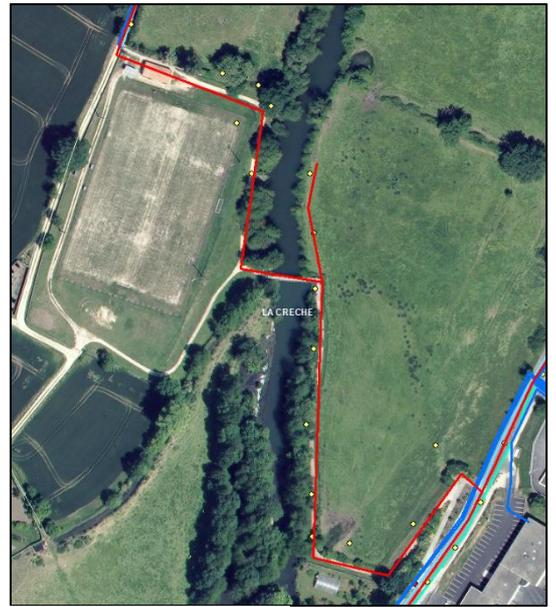
FIGURE 28: AJOUT DE SECTIONS DANS UN PARC (EN FONCTION DES PONCTUELS D'ÉCLAIRAGE)
