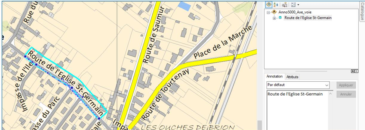
**FIGURE 84: MODIFICATION DE LA LIGNE DE BASE D'UNE ANNOTATION (ET APERÇU DE LA FENÊTRE DE MODIFICATION D'ANNOTATION)**
