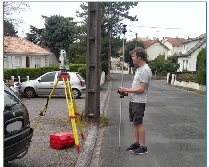
Pour les points relevés sur l'ensemble de la zone test, il a utilisé un GPS Leica GS10 équipé d'un contrôleur CS10. Le GNSS en question capte les constellations de satellites GPS (USA), GLONASS (Russie) et GALILEO (UE).
